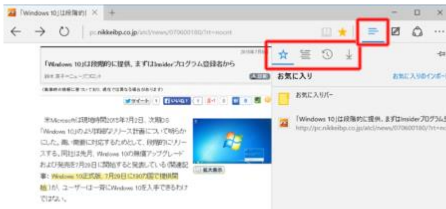
図 14 ● 右上の赤枠が「ハブ」ボタン。お気に入り、履歴、リーディングリスト（Web ページを丸ごと保存したもの）、ダウンロード管理などはここにまとめられている
