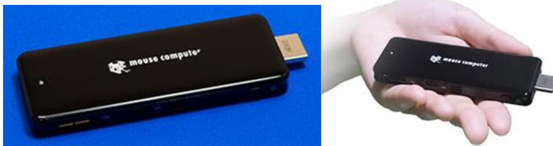
サイズは 100×38×9.8mm (端子含まず)、重量は約 44g とかなりコンパクト。搭載されている CPU はインテルの Atom プロセッサー Z3735F で、メモリ 2GB に 32GB の内蔵ストレージを備えています。スペック的には一般的な Windows 8.1 タブレットと大きな差はありません。
