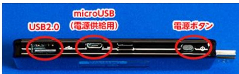
底面には、USB ポート、電源ポート (microUSB)、電源スイッチが配されています。Bluetooth4.0 を搭載しているなので、Bluetooth を利用しての拡張機能を使用することができますが、USB 接続による機器拡張をする場合は USB ハブなどが必要になります。キーボードの購入と合わせ、利用前に準備しておいたほうが良いかと思います。
