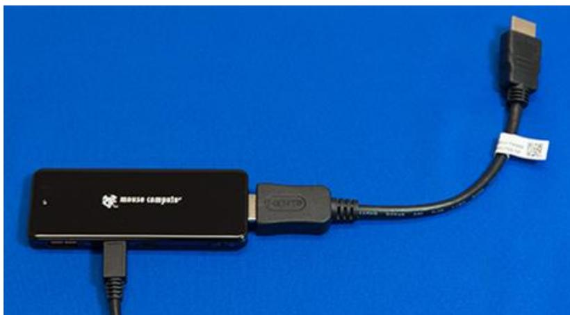
モニターやテレビの HDMI ポートに接続する際、直接挿しにくい場合は付属の延長ケーブルを使用してください。なお本製品利用時には給電が必要です。
